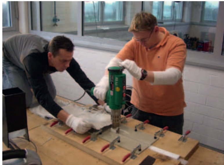
Lehrgangsteilnehmer beim Wärmegasextrusionsschweißen von Polypropylen mit einem Handschweißextruder. (Foto: METZ)
